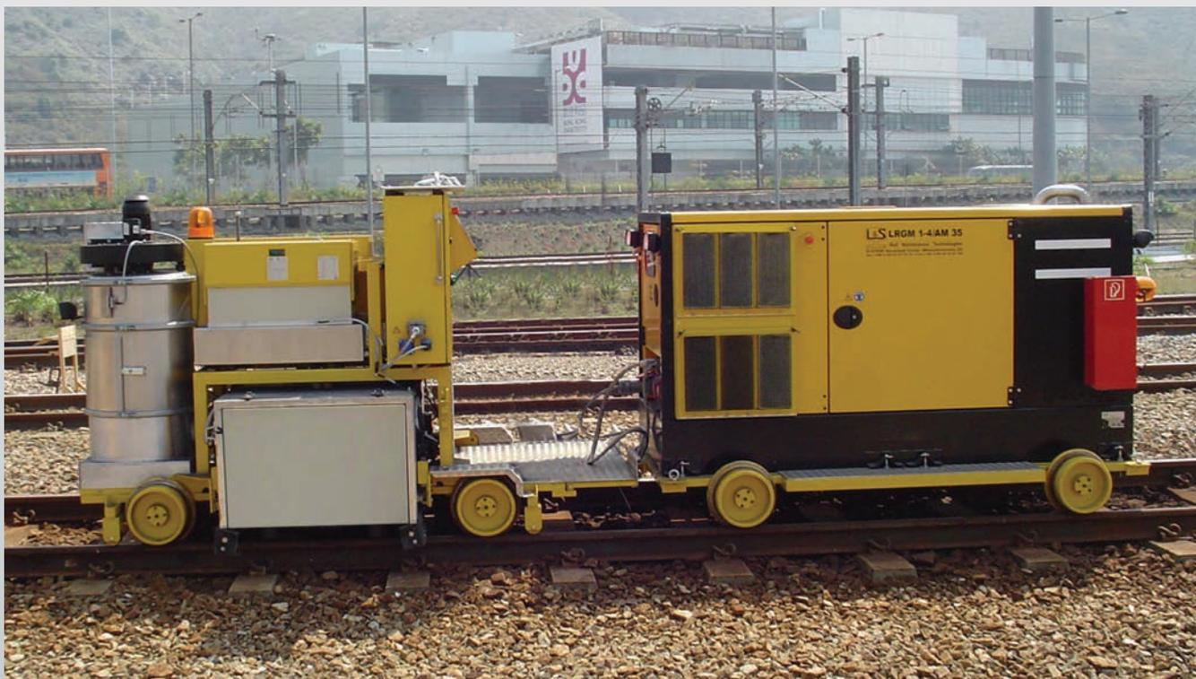
Die LRGM 1-4/ AM 35 ist ein Schleifgerät, das zur Bearbeitung der Schienenoberfläche mit Hilfe eines angehängten Stromerzeugers betrieben wird. Auf diese Weise sind keine Stromversorgungskabel entlang der Einsatzstelle notwendig. Das Schleifgerät lässt sich je nach Bedarf per Rampe von einem Schienenfahrzeug oder per Kran an der jeweiligen Baustelle ein- und ausleisen.
