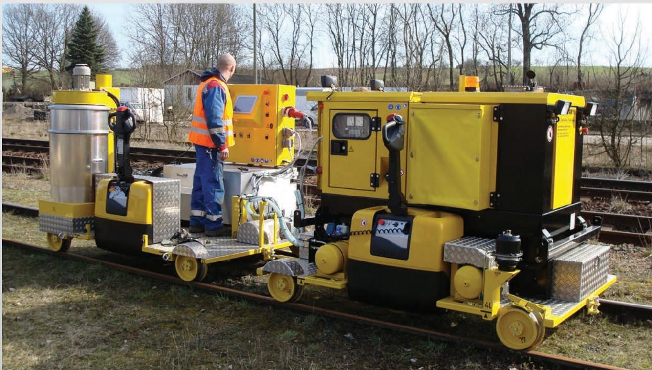
Die LRG 1-2/ AM 16 ist ein Schleifgerät, das zur Bearbeitung der Schienenoberfläche mit Hilfe eines angehängten Stromerzeugers betrieben wird. Auf diese Weise sind keine Stromversorgungskabel in der Baustelle notwendig. Das Schleifgerät lässt sich je nach Bedarf per Rampe von einem Schienenfahrzeug oder per Kran in der jeweiligen Baustelle ein- und ausgleisen.
