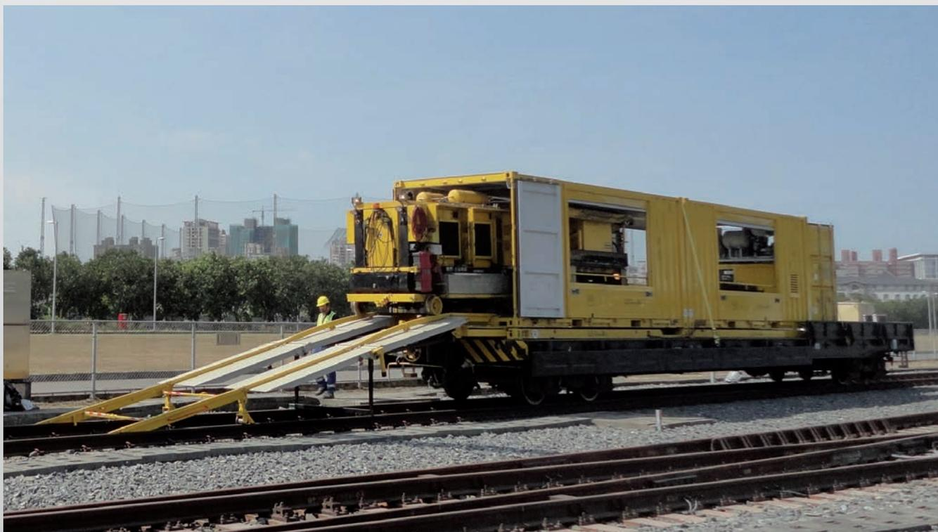
Das CRIO System ist ein Transport- und Eingleissystem für bewegliche Maschinen, die für Prüfungs- und Instandhaltungsarbeiten in Gleisanlagen eingesetzt werden. Es ermöglicht ein besonders flexibles und direktes Zuführen der Geräte zum Einsatzort, ein schnelles Auf- und Ausgleisen sowie den einfachen Transport zur nächsten Einsatzstelle.
